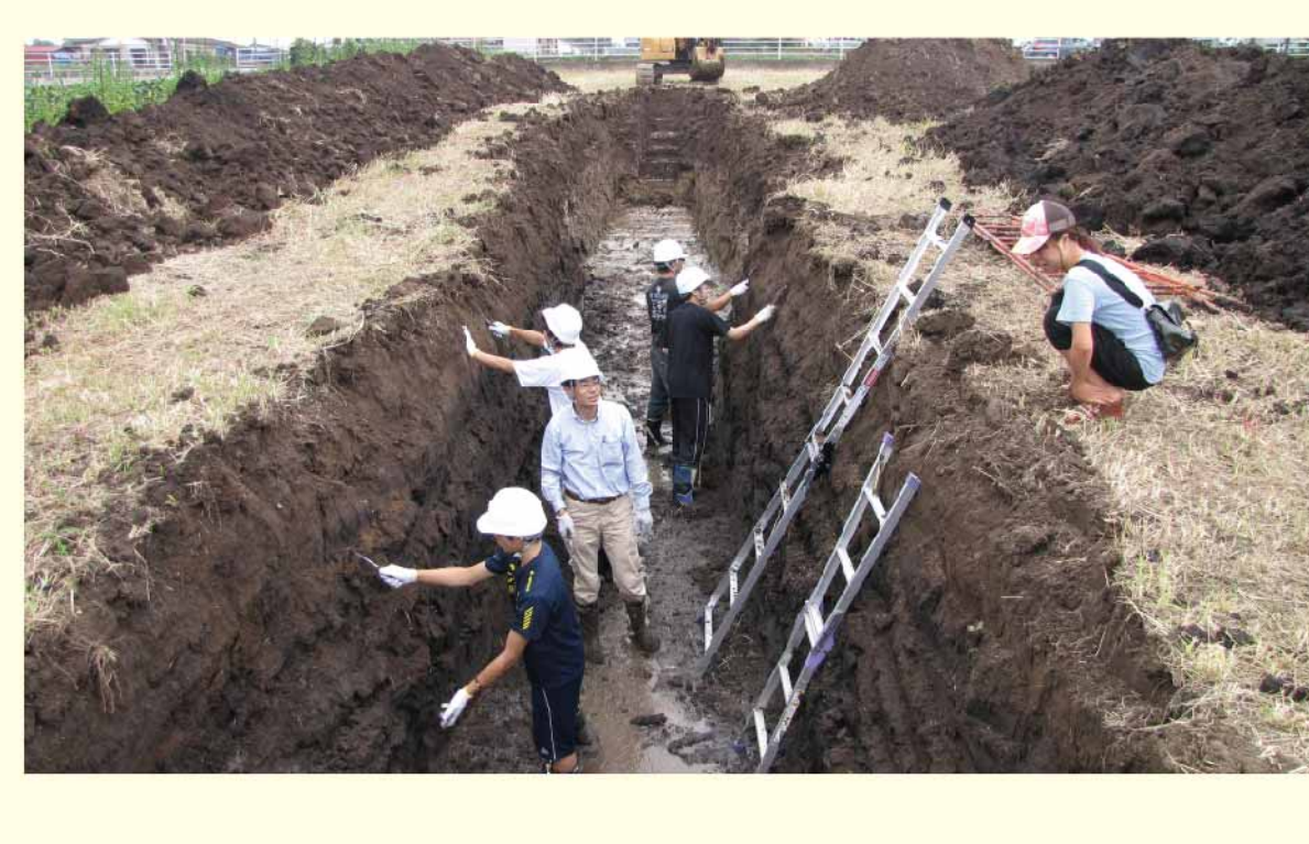
第8図 トレンチ掘削調査の様子。トレンチに現れた壁面の地層を観察します。
