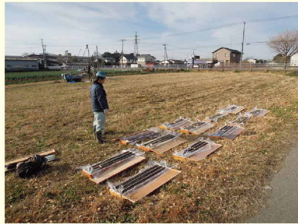
第5図 ボーリング調査で採取した地層。1mごとに地層を採取して、木箱にいられています。
