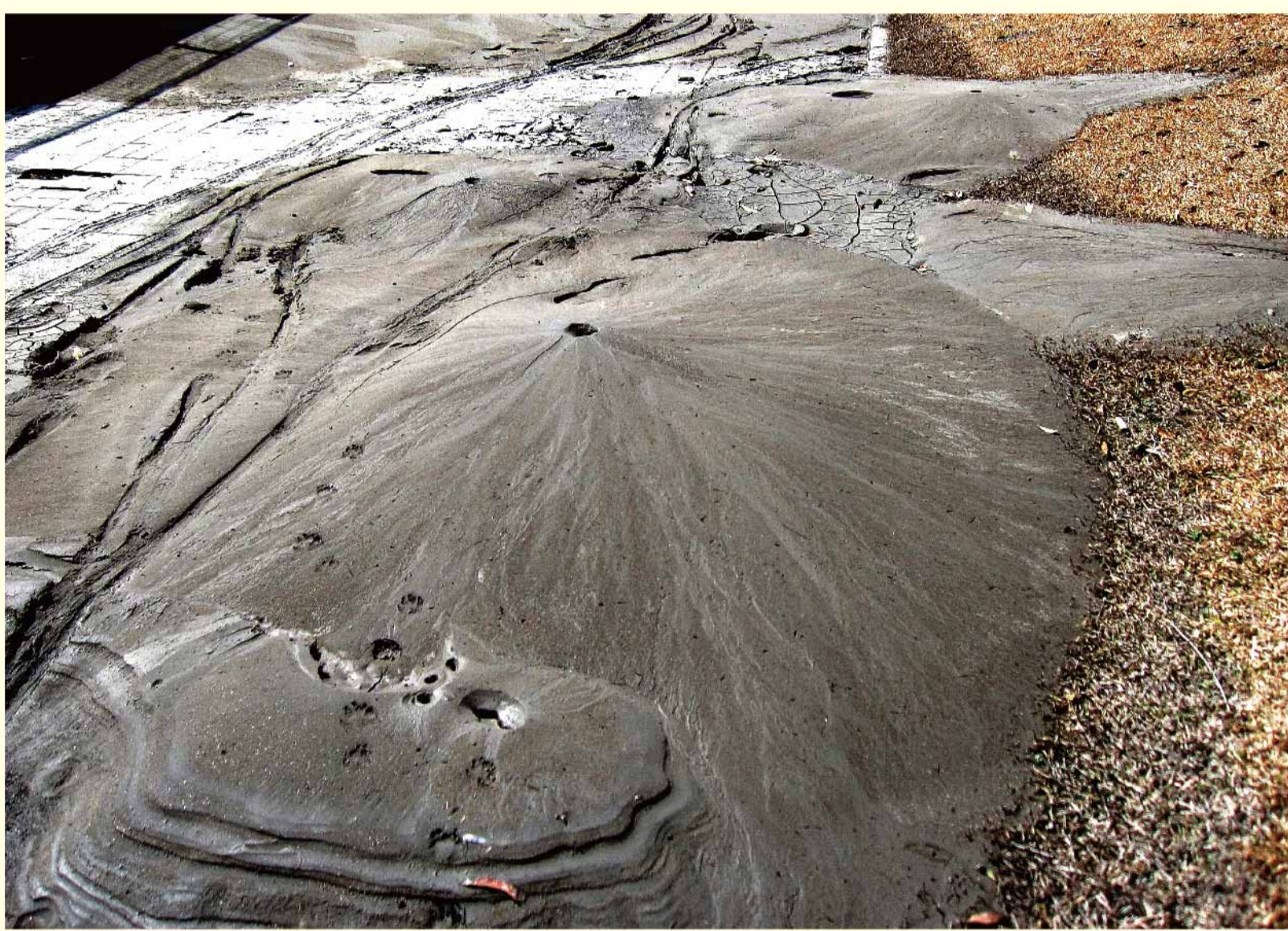
第3図 液状化による円錐状の噴砂 (2011年東北地方太平洋沖地震)
